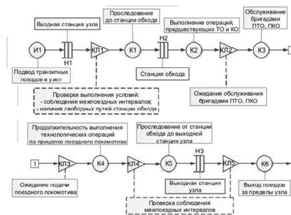
Рис. 3. Функциональная схема пропуска грузовых поездов по обходу
