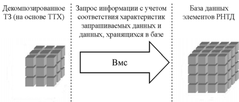
Рис.2. Механизм формирования информационных потоков между базой данных и сформированным техническим заданием на новую работу
